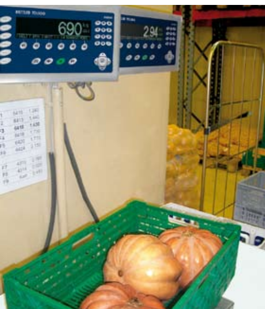
Determinación precisa y que ahorra tiempo del contenido neto con el terminal de pesaje IND690Sys y la plataforma PBA430
