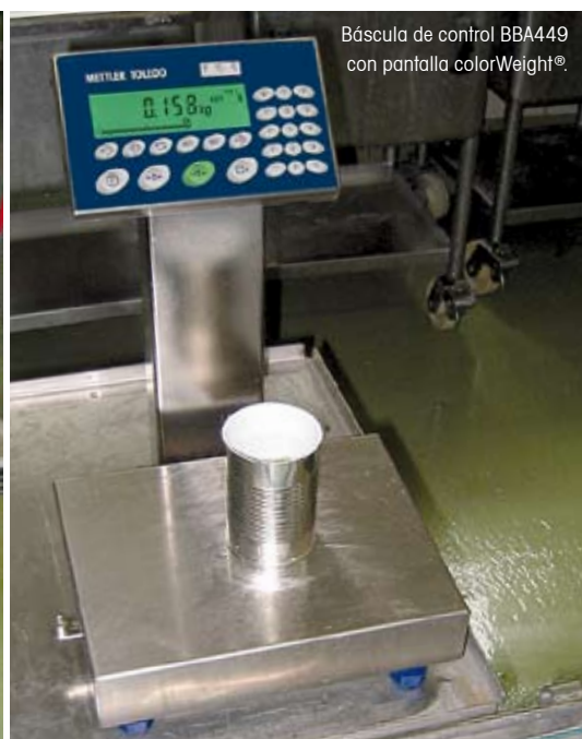
Rechazo automático de latas con llenado insuficiente.
