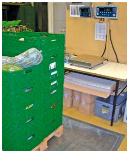
Determinación precisa y que ahorra tiempo del contenido neto con el terminal de pesaje IND690Sys y la plataforma PBA430
